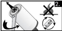
**提示：**為確保注油器運作正常穩定，建議選用原廠配置、經測試的潤滑劑，固態油脂稠密度要求在 NLGI 級別  $\leq 2$ 。請參照以上各建議正確使用及安裝注油器，任何以非正確方式使用及安裝注油器所產生的問題，製造商恕不負責。如有需要，請與您的產品供應商聯繫。
